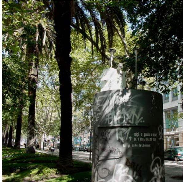
Figura 4: Estação de monitorização da qualidade do ar da Avenida da Liberdade, com o Amostrador no topo
