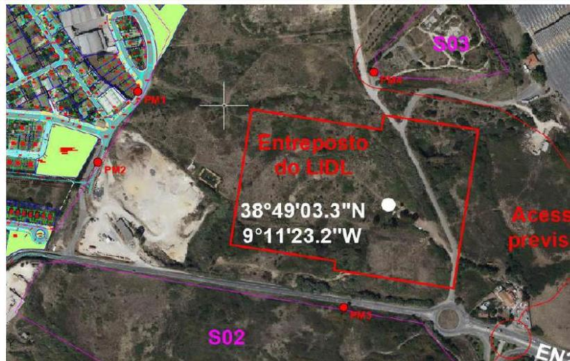
Figura 4 - Pontos de monitorização propostos para a verificação do cumprimento dos requisitos legais (Fonte: RECAPE, julho 2022)
