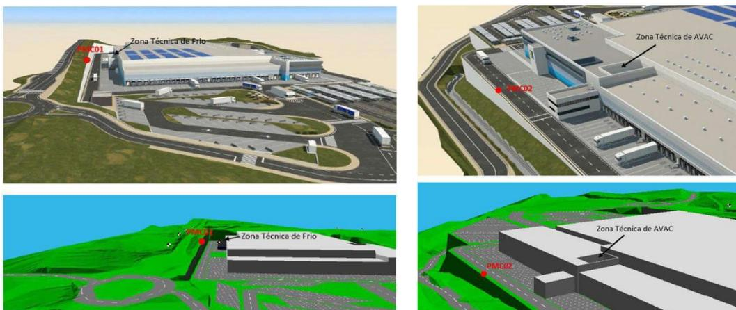
Figura 5 - Pontos de monitorização propostos para controlo da emissão sonora e da eficácia da grelha acústica (Fonte: RECAPE, julho 2022)
