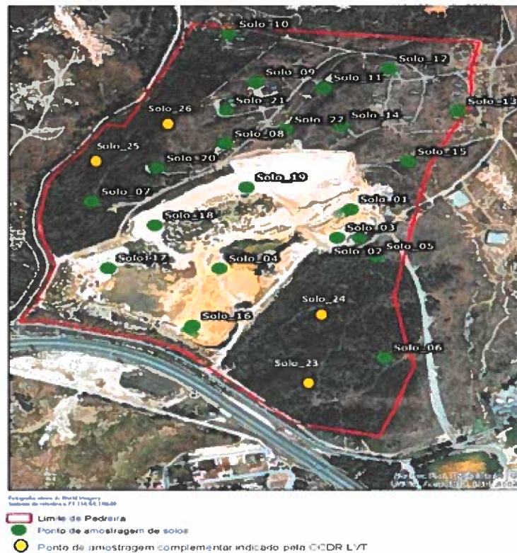
Figura 11: Planta com a localização dos pontos de amostragem para a avaliação complementar do estado do solo
