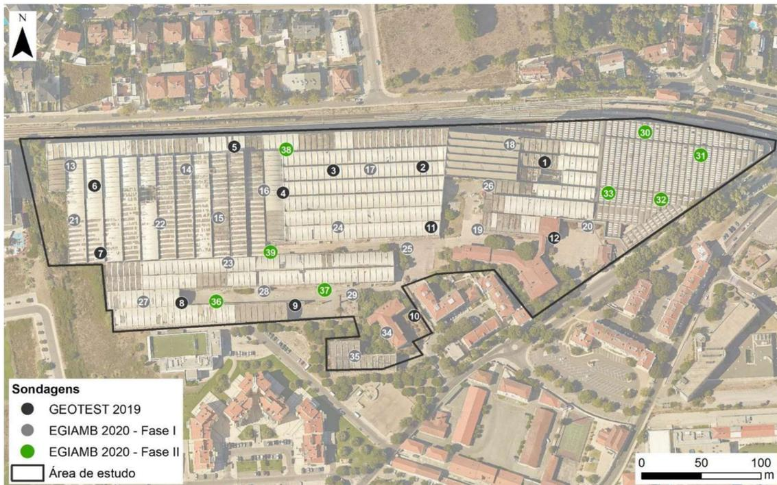
Figura 7: Planta com a localização da malha de amostragem para avaliação do estado do solo
