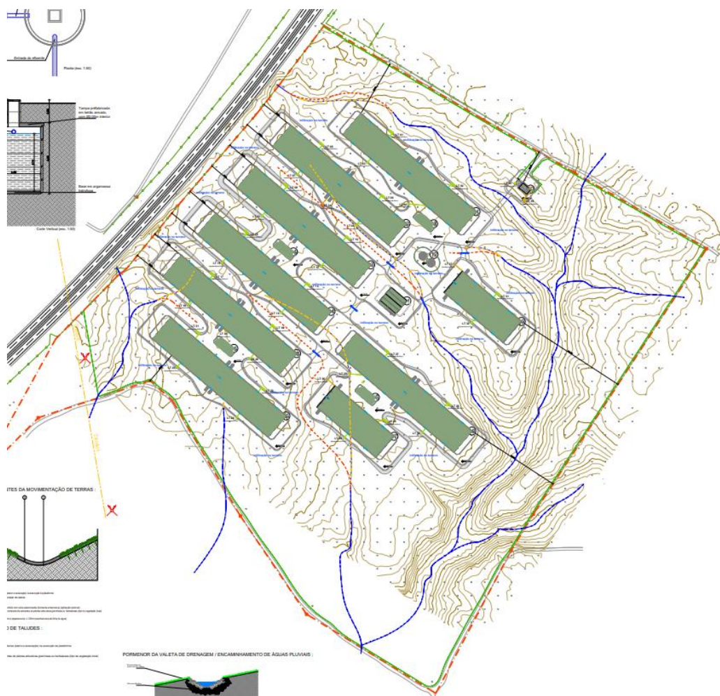
Figura 3 - Extrato da Planta de Implantação - Águas Pluviais (Fonte: Anexo EIA, Peça n.º 11.4 vrs.02)
