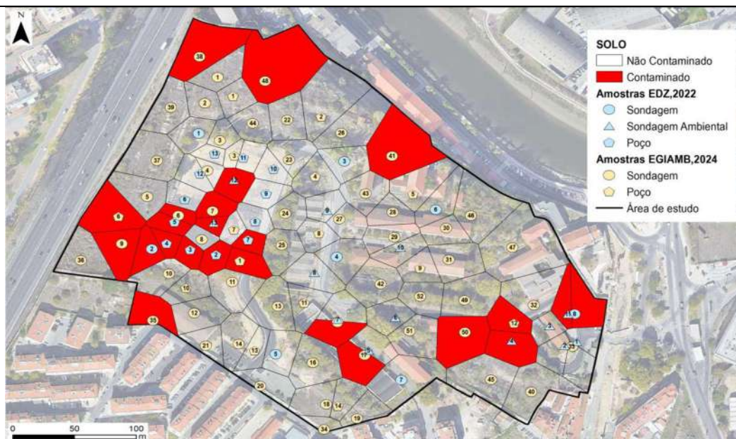
Figura 9 - Representação dos locais contaminados no Antigo Quartel de Sacavém (Fonte: Figura 5.4.2 do RS)
