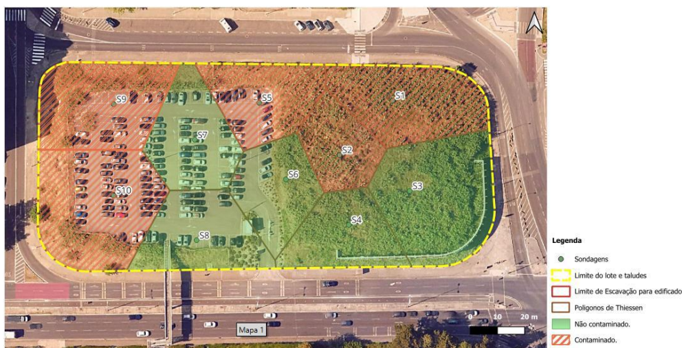
Figura 7 - Planta da delimitação da contaminação, representada à superfície do terreno, na área a escavar:
