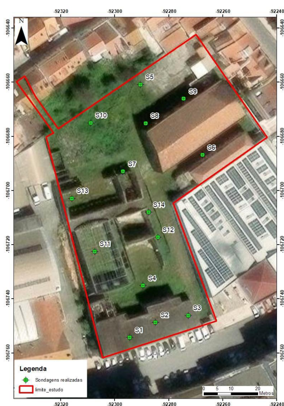
Figura 6 - Planta da malha de amostragem:
